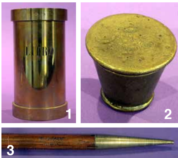
1. Mesura del patró del litre. 2. Quilogram en forma de gots niuats. 3. Extrem del primer metre patró.
