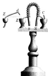
Esquema original de l'electroimant presentat per Sturgeon.
