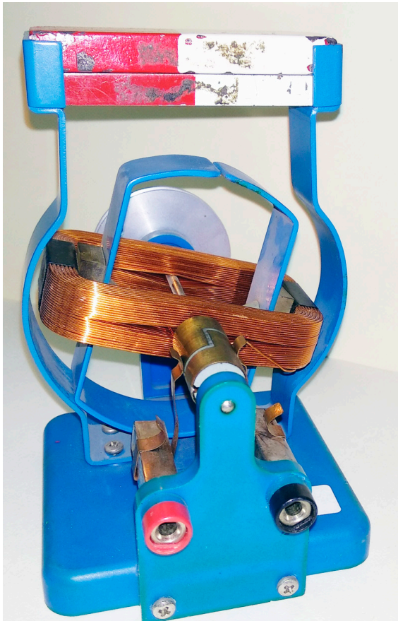
Fig. 3. Motor escolar de corrent continu.
