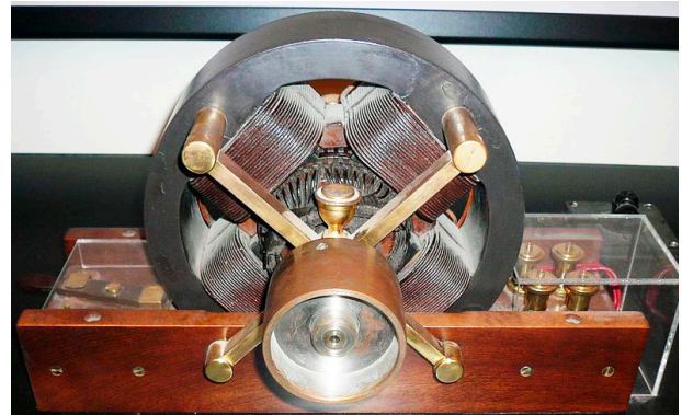
Fig. 4. Motor de corrent altern. Imatge extreta de https://commons.wikimedia.org . Autor: Ctac.
