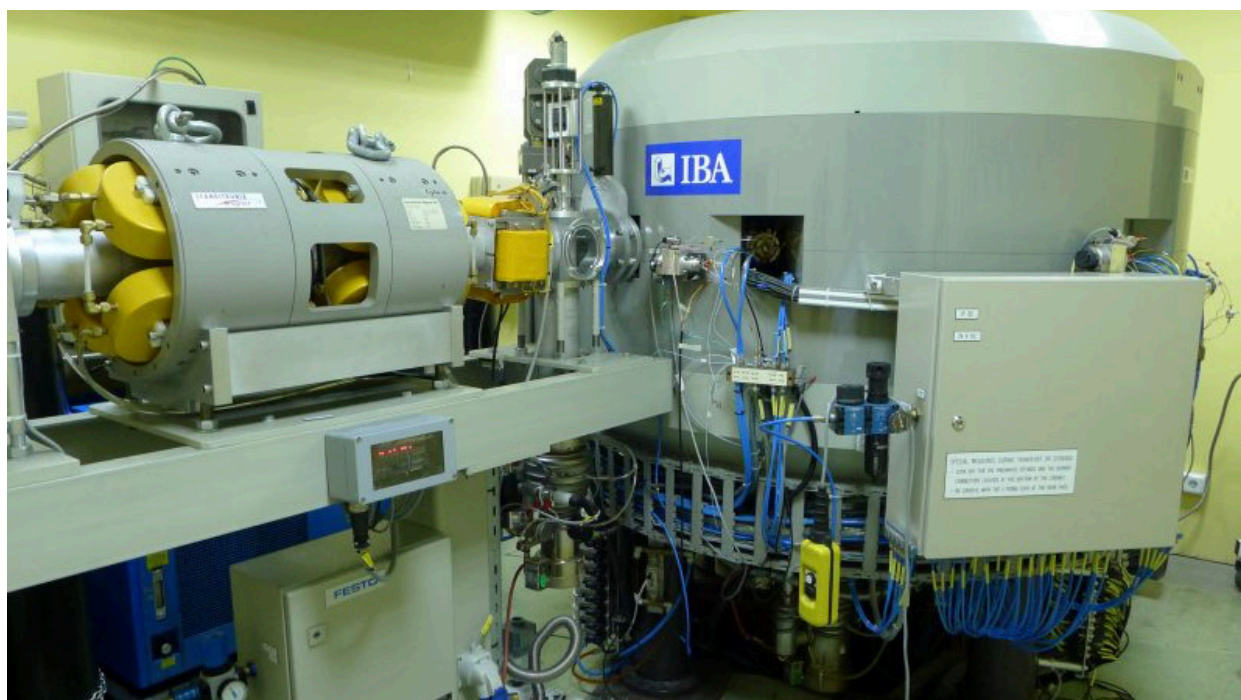
Fig. 5 Ciclotró comercial instal·lat al Centro Nacional de Aceleradores de Sevilla (centre mixt US, Junta de Andalucía i CSIC). Pot accelerar protons o deuterons per a produir alguns radioisòtops emissors de positrons.
