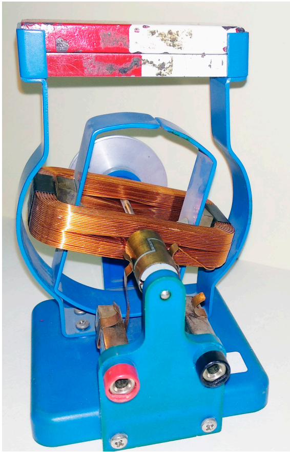
Fig. 3. Motor escolar de corrent continu.
