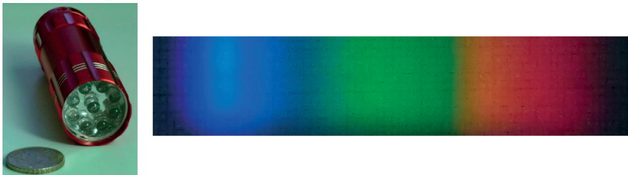
Llanterna de mà que produeix llum blanca mitjançant nou leds. Un únic led produeix una intensitat lluminosa baixa, però les seues reduïdes dimensions permeten agrupar-los per aconseguir una intensitat suficient. A la dreta, espectre de la llum que emet.
