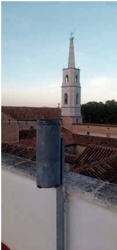
Figura 2. Pluviòmetre en el terrat del convent.
