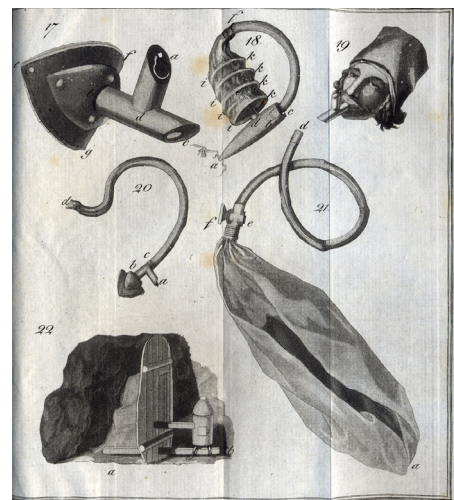
Màscara per als miners, 1799. Aquest prototip va servir d'inspiració per a la creació de les actuals màscares antigàs d'ús bèl·lic.
