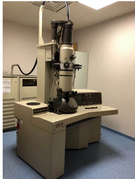
Microscopi electrònic Phillips CM10. Imatge cedida pel Centre de Recerca Príncep Felip
