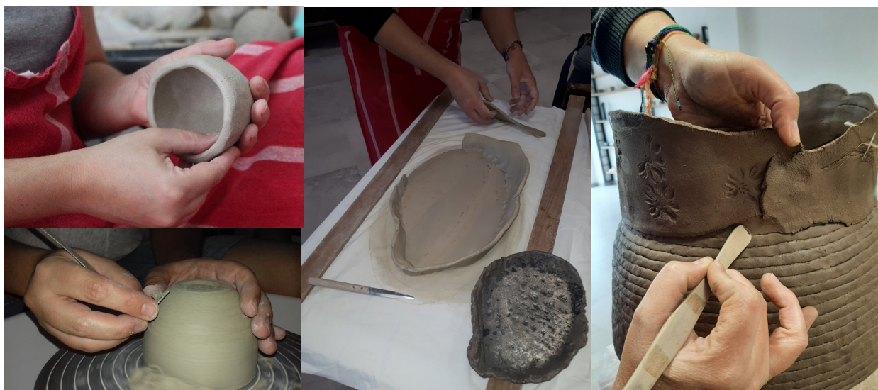
Tècnica de pissic. Repassat de les peces al torn. Tècnica de xurros. Treball per planxes.
