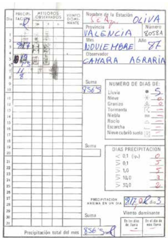
Figura 3. Targeta d'observació de la precipitació de l'estació d'Oliva del mes de novembre de 1987. Mireu-hi el registre dels 817 l/m 2 del dia 3.
