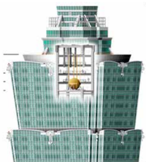
Amortidor de massa del Taipei i ubicació en l'edifici. https://es.wikipedia.org/wiki/Amortiguador_de_masa i https://es.m.wikipedia.org/wiki/Archivo:Taipei_101_Tuned_Mass_Damper.png
